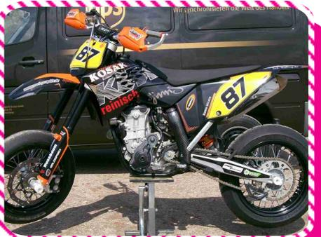
Während die nahezu serienmäßige Motorleistung um die 65 PS für die meisten Piloten ausreicht, tritt kein Fahrer mehr ohne die Supermoto-typischen Fahrwerks-umbauten auf 17-Zoll-Rädern an, um mit den im Strassenrennsport üblichen Slick- oder Regenrennreifen fahren zu können. Stärkere Bremsen bringen auf Asphalt ausreichend Verzögerung.
